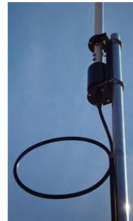
Ilustración 13. Antena vertical
