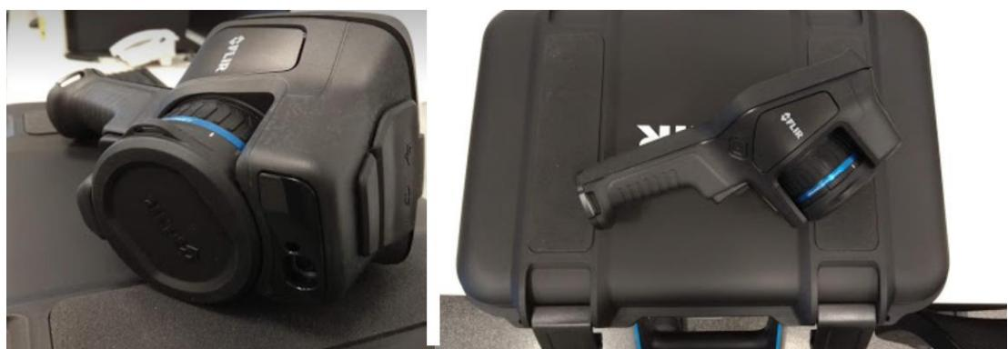
Ilustración 89. Cámara FLIR E85.
