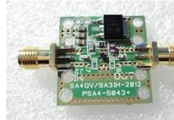
Ilustración 9. LNA 28 - 2500 MHz.
