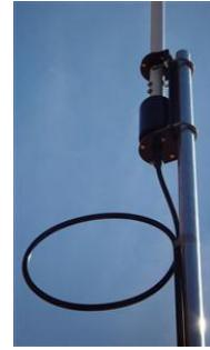
Ilustración 91. Antena vertical 3.5-57 MHz.
