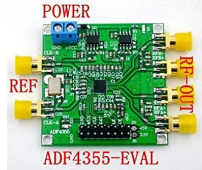
Ilustración 88. Generador RF basado en ADF4355.
