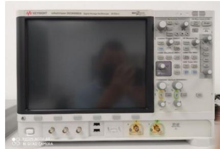
Ilustración 3. Agilent Infinivision DSOX6002A.
