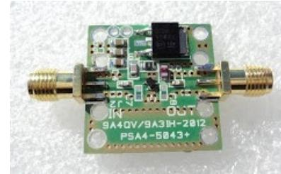
Ilustración 87. LNA 28 - 2500 MHz.
