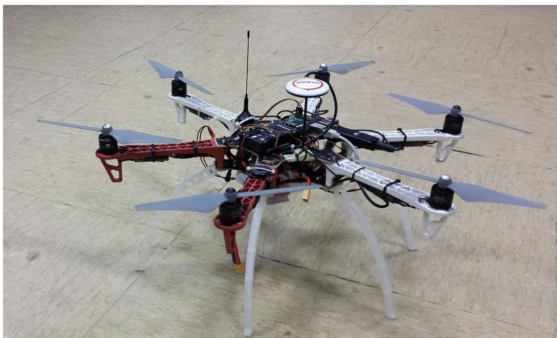
Ilustración 77. Multicóptero DJI F550.
