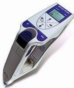
Ilustración 21. Mettler Toledo Densito 30 PX.
