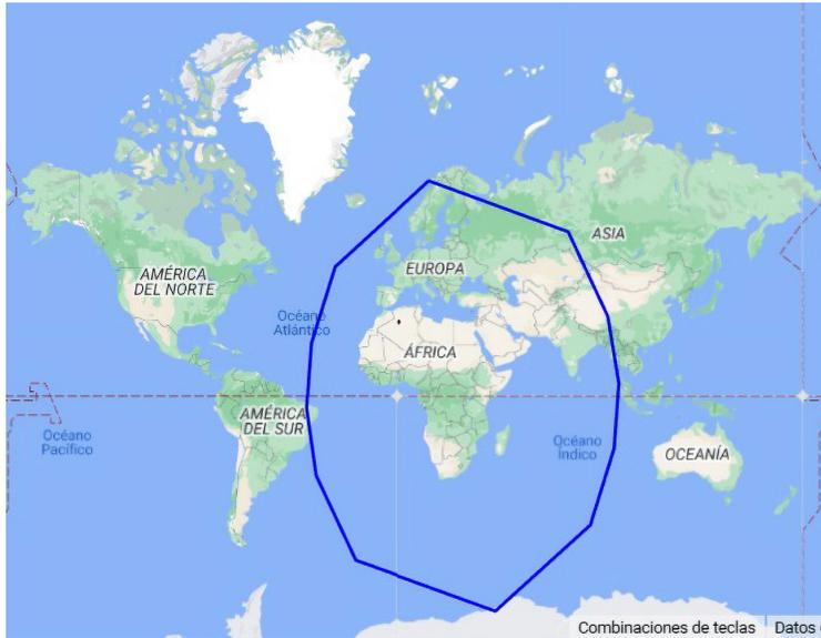
Figura 2. Diagrama aproximado de haz global (17°) sobre la posición 29° E (calculado con)
