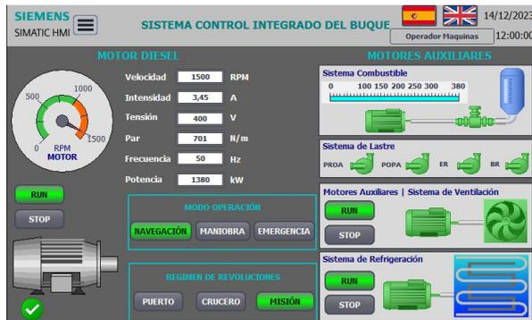
Figura 2. Panel de control de la cámara de control de máquinas del HMI
